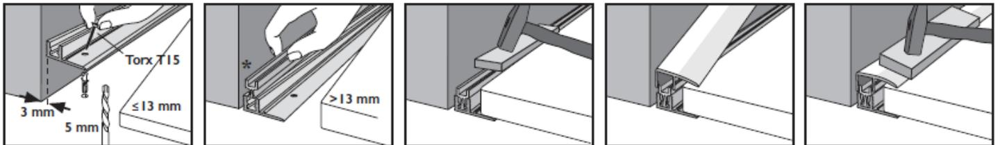
Das Basisprofil mit ca. 3 mm Abstand zur Wand montieren, bei Einbauhöhen > 13 mm beiliegendes Erhöhungsprofil verwenden.
