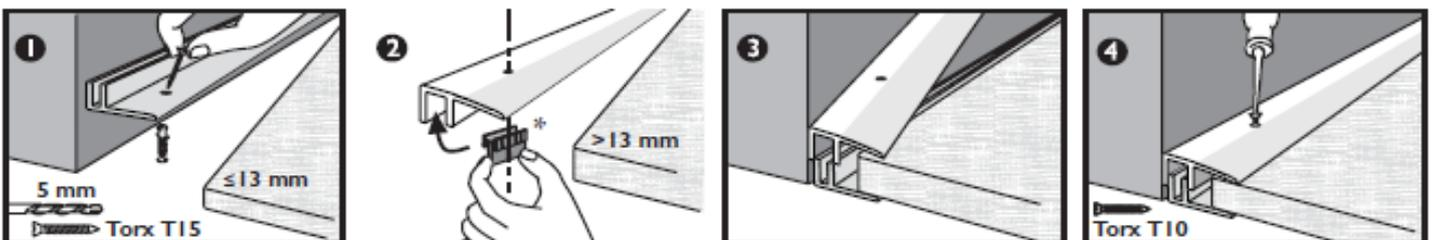
Das Basisprofil mit ca. 3 mm Abstand zur Wand montieren, bei Einbauhöhen > 13 mm beiliegende Erhöhungsteile verwenden.
