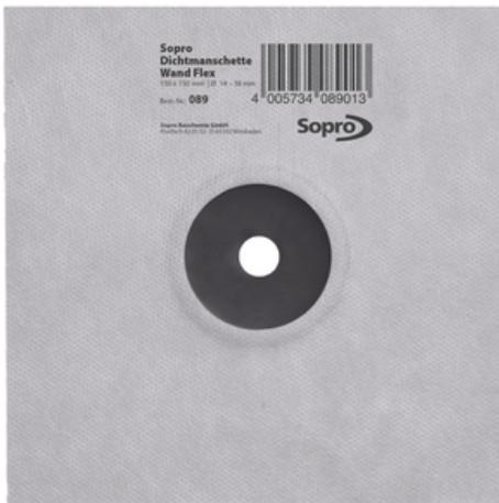
Flexible, alkalibeständige Dichtmanschette zum Abdichten von Rohrdurchführungen von 14 – 38 mm unterhalb von Fliesen und Platten bei der Herstellung wasserundurchlässiger Systeme. Optimaler Haftverbund zu allen flüssig zu verarbeitenden und bahnenförmigen Sopro Abdichtungsstoffen.
